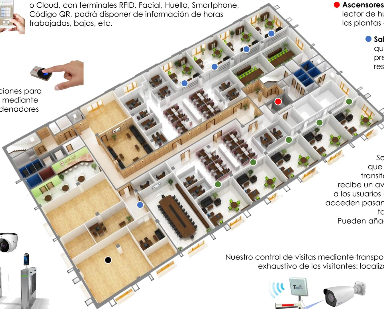
● **Ascensores:** En el interior del ascensor se instala un lector de huella que ofrecerá un acceso limitado a las plantas de dirección, aparcamientos, etc.
